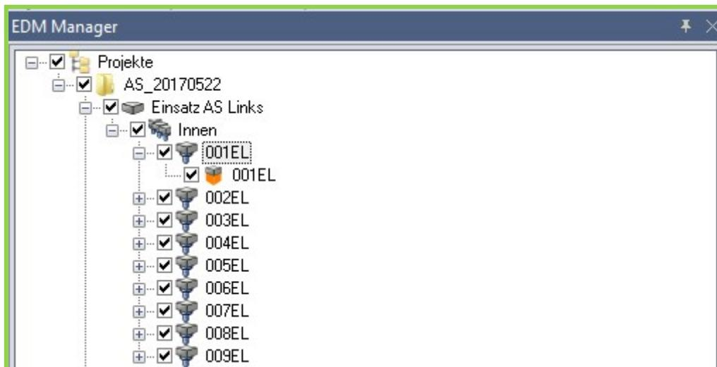
Es kann nun die gleiche Elektrode mit einer weiteren CAM Vorlage und geändertem Funkenspalt bearbeitet werden. Es ist dann auch möglich, anhand der **[Definition Elektrodenbearbeitung]** das bereits existierende Projekt wieder zu verwenden, hierfür muss der Befehl **[Existierendes Projekt wieder verwenden]** jedoch aktiviert werden.
