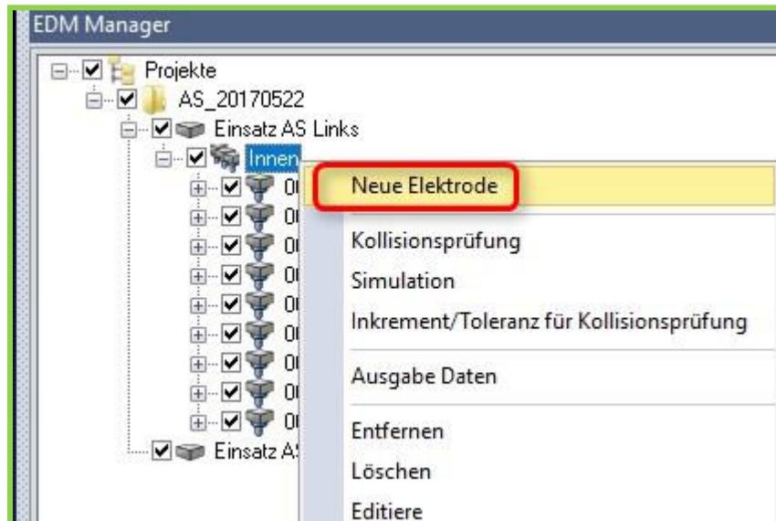
⇒ Im nächsten Schritt muss nun der Körper, siehe Layer mit Index Nr.10, gewählt und das Hinweisfenster mit [Ja] bestätigt werden. Nun können in dem folgenden Elektroden-Rohteil-Menü die Elektrodeneigenschaften wie Name, Material, Elektroden-Typ (Schruppen+Funkenspalt+Anzahl) Rohteilgröße, Nullpunkt ... vergeben werden.
